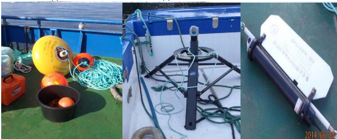
Doppler måler: Profiler 400 KHz Måle område: Opptil 70 meter
